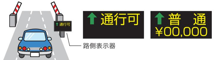
ETCカードの挿入忘れなどで、開閉バーが開かない場合があります。路側表示器に【ストップ停車】と表示されます。
